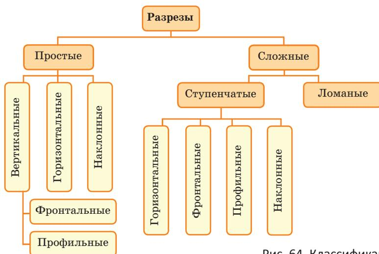
Рис. 64. Классификация разрезов
